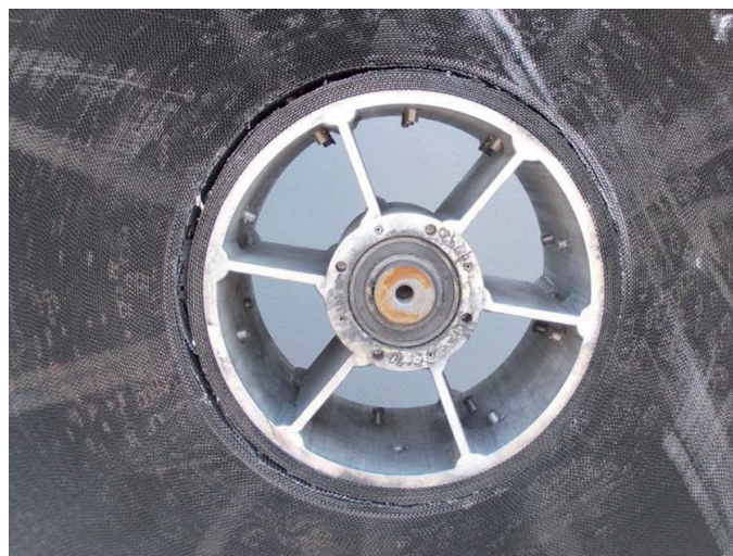
Obr. 10 Poškození výztužných tyčí a uvolnění návinu rotoru
