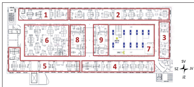
Obr. 2 Půdorys 3. NP s vyznačenými sekcemi CHIT (v sekci „7“ je vyznačeno schéma jedné z regulovaných větví systému)
