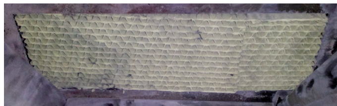
Obr. 4 Ustavení katalyzátoru v místě nad ohništěm (pohled zdola) Fig. 4 Positioning of the catalyst above the fireplace (bottom view)
