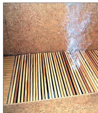
Obr. 4 Zviditelnění konvekčních proudů výdechového otvoru
