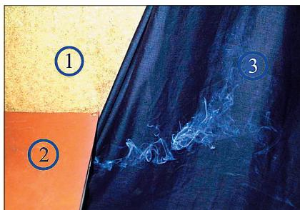
Obr. 6 Obtékání výdechové mřížky stranou je důvodem stagnace křivek v levé části grafu na obr. 3
