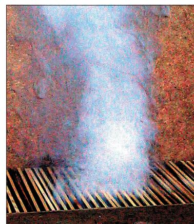
Obr. 5 Zviditelnění konvekčních proudů výdechového otvoru
