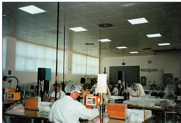
Obr. 1 Sdružené osvětlení pracoviště – denní osvětlení potlačeno vertikálními žaluziemi, umělé osvětlení celkové a místní
