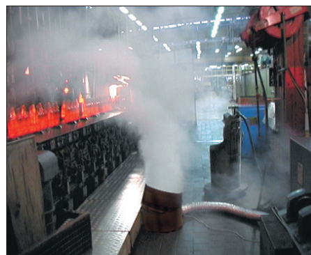
Obr. 7 Vizualizace proudění vzduchu ze spodní vzduchové sprchy na pracovním místě u sklářské linky
