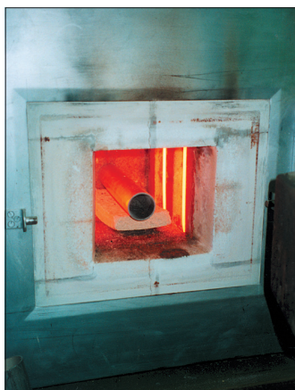
Obr. 1 – Ohřev zkušební vzorku trubky v elektrické peci
