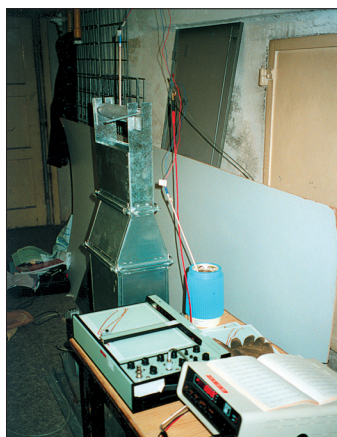
Obr. 2 – Zkušební trať při testování chlazení vzorku trubky
