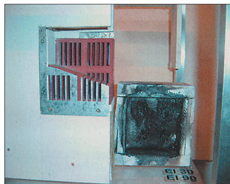
Obr. 6 – Větrací tvarovka před a po požáru
