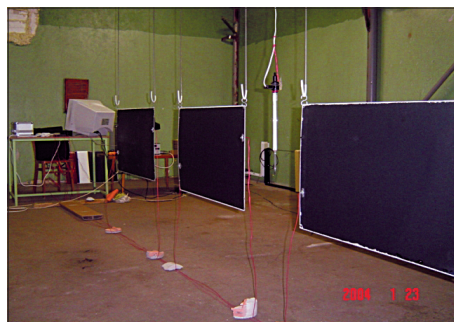
Obr. 1 – Pohľad na zavesené sálavé panely
