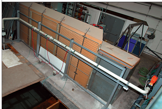
Obr. 2 Experimentální trasa pro měření místní tlakové ztráty ve spoji plastových trub z PP Schéma zařízení (nahoře): 1 – hydrodynamické čerpadlo, 2 – elektromotor s frekvenčním měničem, 3 – PP potrubí, 4 – regulační armatura, 5 – indukční průtokoměr, 6 – spoj svařením na tupo, 7 – odběry statického tlaku, 8 – diferenční snímače tlaku, 9 – A/D převodník, 10 – PC
