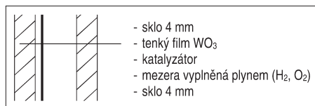
Obr. 3 Skladba gasochromního zasklení
