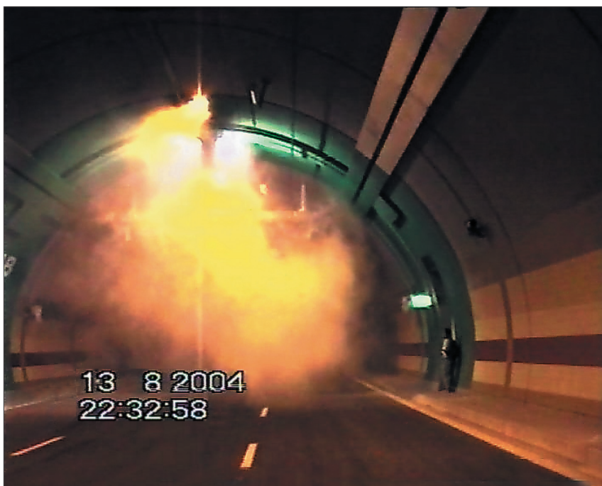
Obr. 5 Zkouška chladným kouřem
