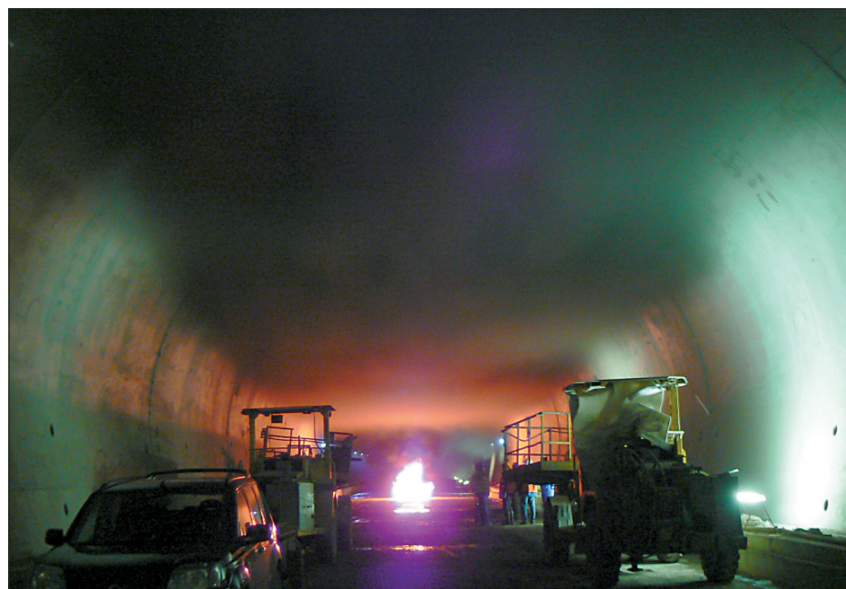
Obr.2 Stratifikovaná vrstva kouře (backlayering) při požární zkoušce v tunelu Klimkovice
