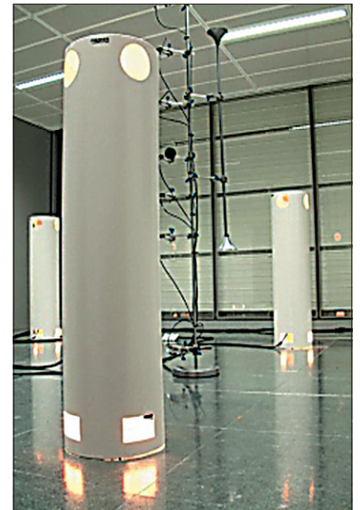
Obr. 2 Příklad simulátorů tepelné zátěže a měřícího zařízení v testovací místnosti [8]
