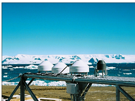
Obr. 7 Měření slunečního záření dopadajícího na vodorovnou plochu
