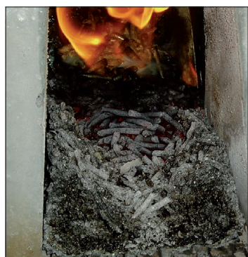
Obr. 2 Fotografie spalovací komory se spečeným popelem
