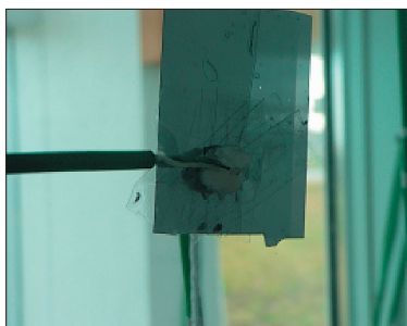
Obr. 7 Měření povrchové teploty stěn Obr. 8 Měření povrchové teploty skleněných tabulí
