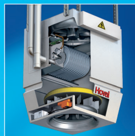
TopVent® DGV. Cirkulační jednotka s plynovým ohřevem pro vytápění vysokých prostor.
