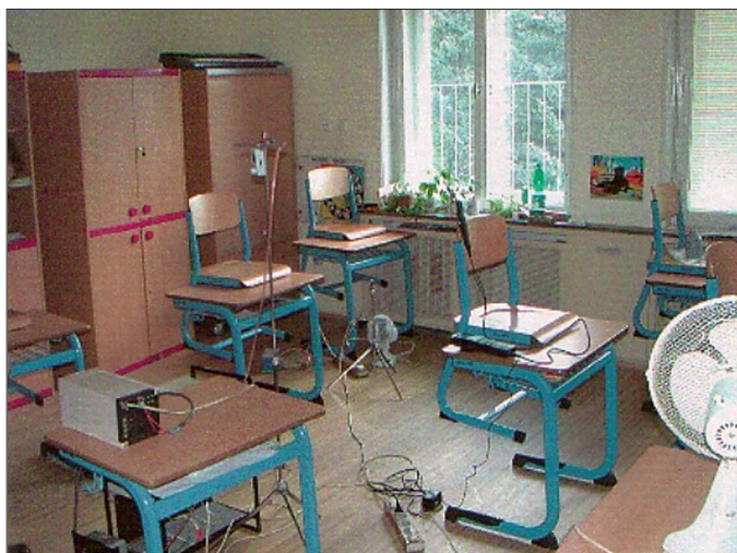
Obr. 1 Školní třída cca 80 m 3 , 15 žáků + učitel, utěsněná dřevěná dvojitá okna (protihluková úprava), vnitřní teplota t_i = 21,0 °C, venkovní teplota t_o = 13,5 °C – způsob měření násobnosti výměny vzduchu indikačním plynem
