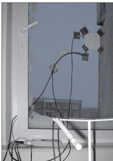
Obr. 3 Pohľad na meranie hustoty tepelného toku a teplotu na zasklení okna
