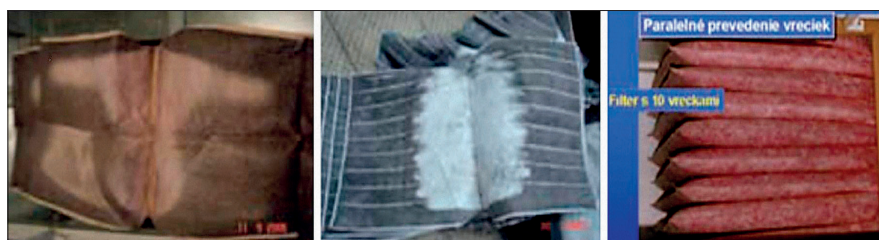
Obr. 7 Filtry s paralelně šitými kapsami v praxi. Vpravo – dotýkající se kapsy v provozu [1]
