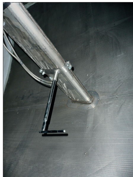
Obr. 1 Detail Prandtlouvy sondy a její uchycení na svorníku
