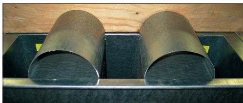
Obr. 7 Náběhové plechy modifikovaného převáděcího otvoru s tlumičem hluku (vlevo); tlakové ztráty (nahore) [6]
