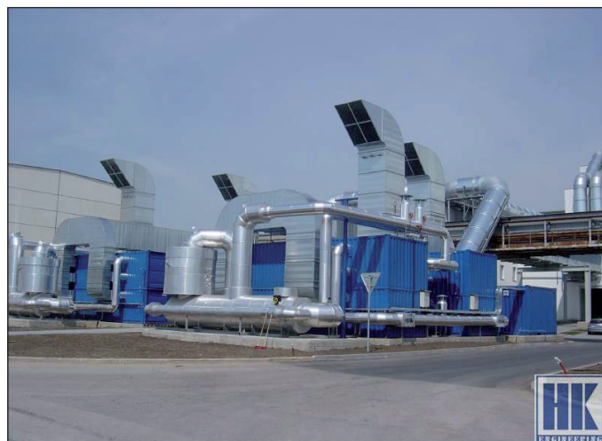
Obr. 6 Foto adsorpčního zařízení s regenerací nasyceného adsorbentu horkým vzduchem [5]
