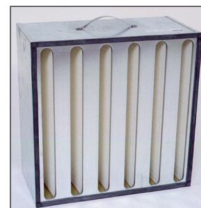
Obr. 5 Vysoce účinný filtr typu HEPA, ULPA s účinností \geq 99,95 (H13), \geq 99,995 (H14) a \geq 99,999\ 5 (U15)
