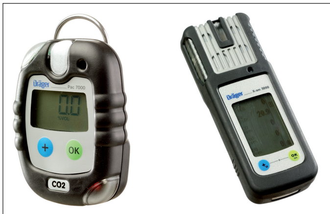
Obr. 7 Příklady přenosných přístrojů pro měření koncentrace CO 2 (Dräger Pac 7000 s elektrochemickým senzorem a Dräger X-am 5600 s IR senzorem)
