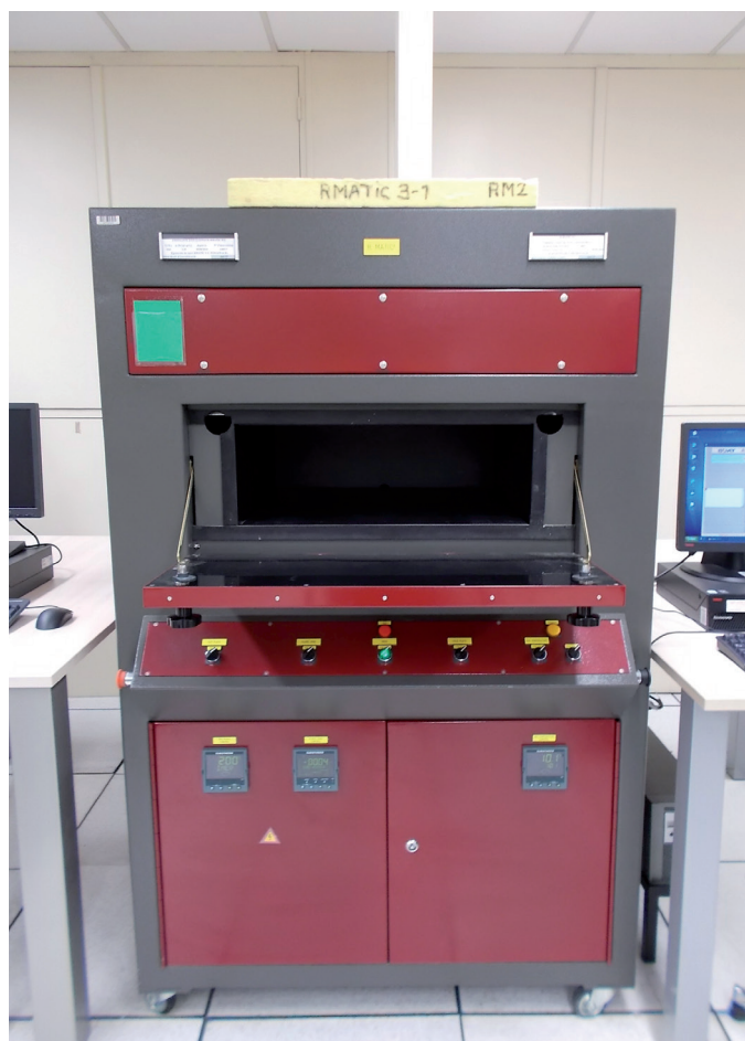
Obr. 1 Měřicí zařízení pro stanovení součinitele tepelné vodivosti izolačních materiálů metodou chráněné topné desky a měřidla tepelného toku podle normy ČSN EN 12667
