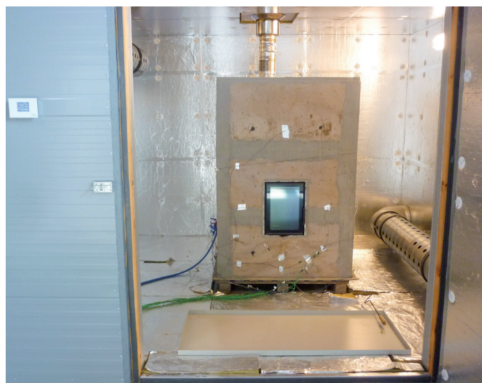
Obr. 7 Varianta č. 4 – sálavý akumulční krb připravený pro zkoušky v kalorimetrické komoře
