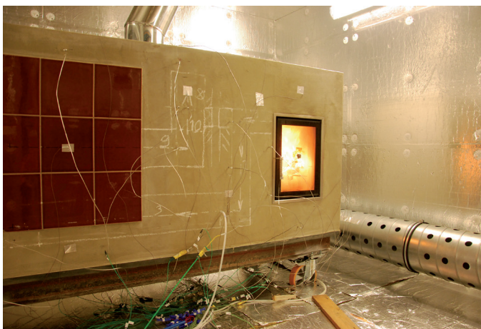
Obr. 11 Individuálně stavěná kamna dle ČSN EN 15544:2013 při zkouškách v kalorimetrické komoře
