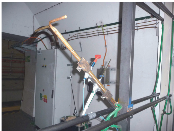
Obr. 5 Rozmístění Prandtlových sond pro měření statického tlaku, termoanemometru a vrtulkového anemometru pro měření rychlosti proudění v jednom bodě
