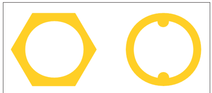
Obr. 5 Použité typy testovaného šroubení pro připojení vodoměru k potrubní trati – vnější šestihranné nebo s vnitřními náličky
