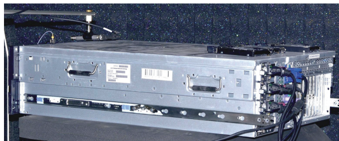
Obr. 14 Server proměřovaný v akustické laboratoři
