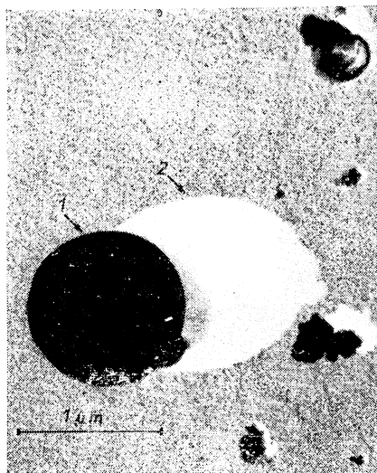
Obr. 4 a obr. 5. Snímky olejového aerosolu ze strojírenské haly jako v obr. 3; odebráno termoprecipitátorem na uhlíkovou nosnou blanku, pokoveno Au-Pd pod úhlem 45^\circ ; (1 — částice olejového aerosolu, 2 — vržený stín částice).
