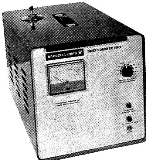
Obr. 1. Celkový vzhled Elektro-optického počítace častic firmy Bausch a Lomb.
