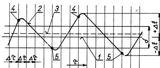
Obr. 5. Časový průběh teploty topného tělíska (1 — teplota horní desky přístroje, 2 — teplota topného tělíska, 3 — střední teplota topného tělíska, 4 — okamžik přerušování elektrického topného obvodu, 5 — okamžik sepnutí elektrického topného obvodu, \Delta t — rozdíl teploty od střední hodnoty, která odpovídá nulové poloze padáčkového regulátoru, \delta — spínací teplotní rozmezí padáčkového regulátoru, \Delta \tau — časový spínací interval padáčkového regulátoru určující okamžiky možné změny topné funkce).
