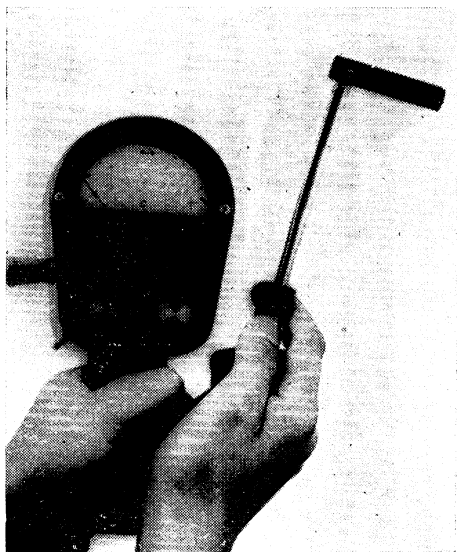
Obr. 7. Termo-anemometr fy WALLAC FINLAND slouží k rychlému určení rychlosti, průtoku i teploty vzdušiny.
