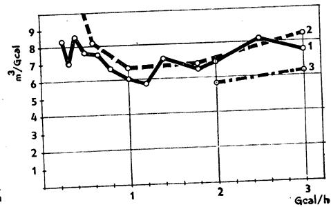
Obr. 5. Měrný obestavěný prostor kotle na jednotku výkonu. (1 — kotel OMNIMAT OW, 2 — kotel TURBOMAT — L., 3 — kotel TURBOMAT — L.).
