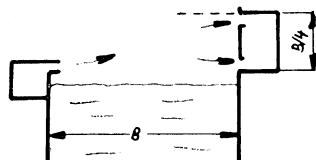
Obr. 10. Odsávání s přefukem — dimenzování
