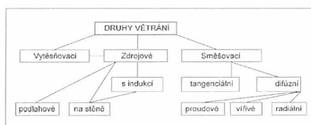
Obr. 1 Rozdělení klimatizačních systémů podle druhu větrání
