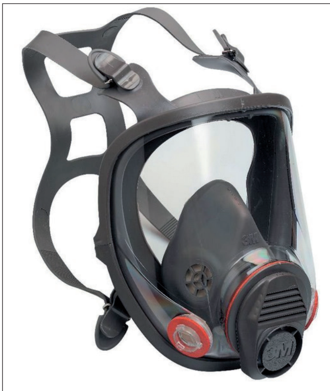
Obr. 9 Ochranná maska: dva filtry po stranách, dobré přilnutí k obličeji, ochrana na oči, menší zorné pole, bajonetový úchytný systém filtrů
