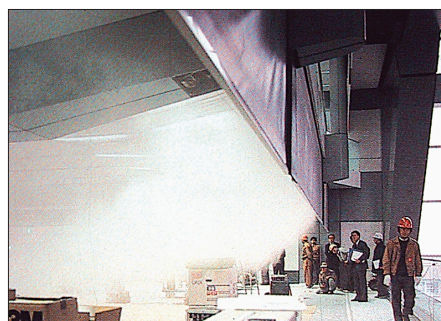
Obr. 5 Kouřové zkoušky na hotové budově
