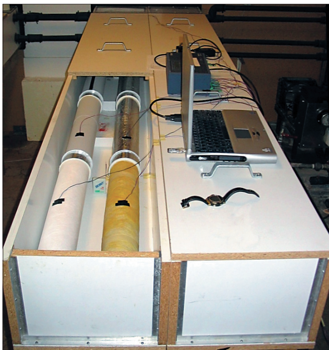
Obr. 3 Vzorok izolace ve zkušebním kanále
