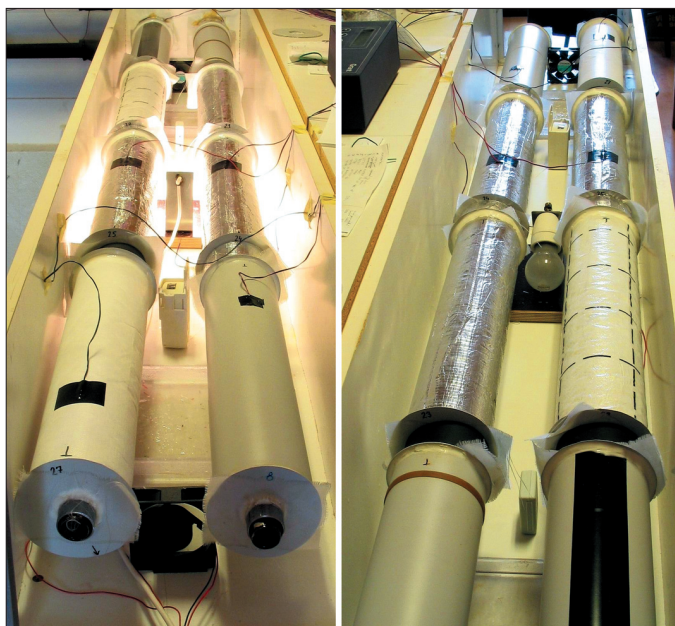
Obr. 5 Uspořádání žárovky, dvou ventilátorků a dvou vaniček v horizontálním zkušebním kanále
