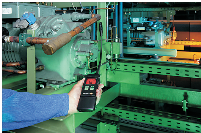
Obr. 3 Detektor úniku chladiv se sondou s extrémně dlouhou životností testo 316-4
