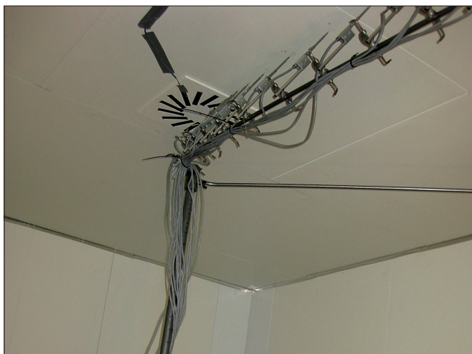
Obr. 4 Pohled na část polohovacího mechanismu – otočné nosné rameno se sondami
