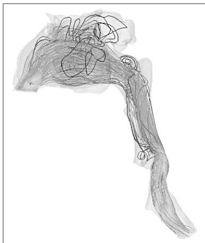
Obr. 1 Trasy částic v horních cestách dýchacích při nádechu (ustálené proudění)
