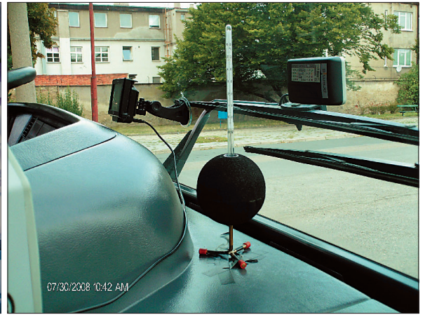
Obr. 2 Umístění kulového teploměru na přístrojové desce
