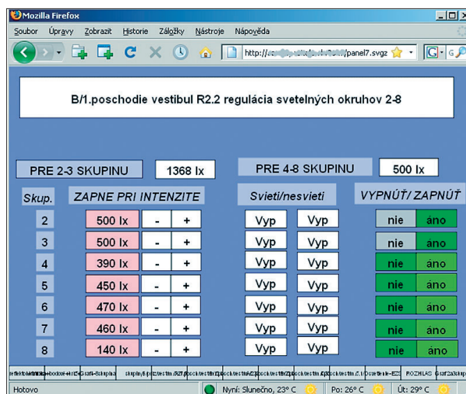
Obr. 2 Jednoduchý webový přístup k nastavení řízení světla v komerčním objektu
