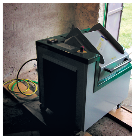
Obr. 2 Zařízení na dekontaminaci pomůcek pro inkontinentní pacienty (pleny, podložky aj.)
