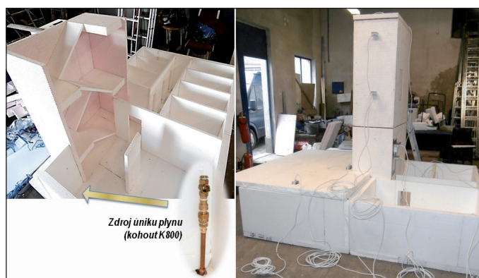
Obr. 5 Část členitého prostoru (sklepení a schodiště) a měřicí souprava
