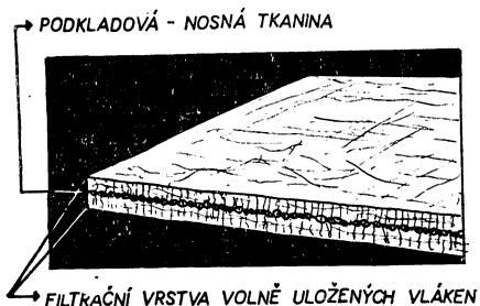
Obr. 4. Znáznornění nového provedení filtrační látky.
